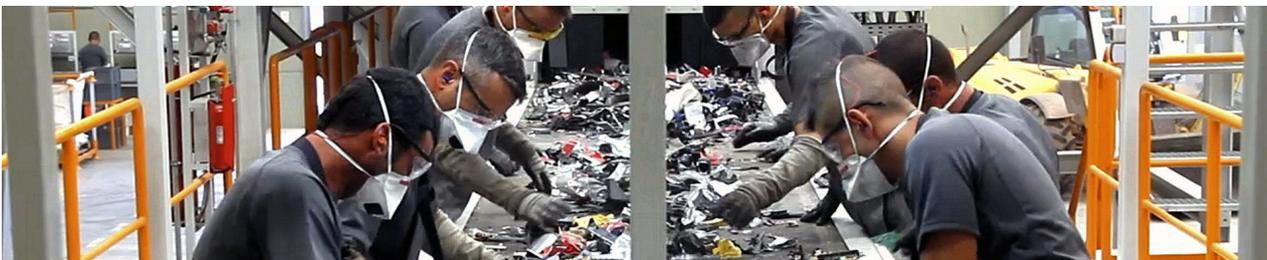
Descripción: Separación de componentes electrónicos mediante técnicas manuales o automatizadas para recuperar partes valiosas.
