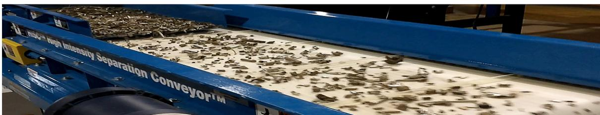
Descripción: Utilización de imanes para separar materiales ferrosos y no ferrosos presentes en la chatarra electrónica.
